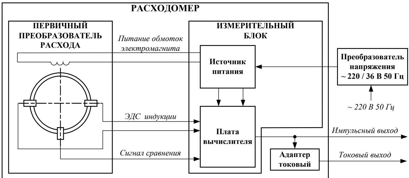
Рис. 1. Структурная схема расходомера.
