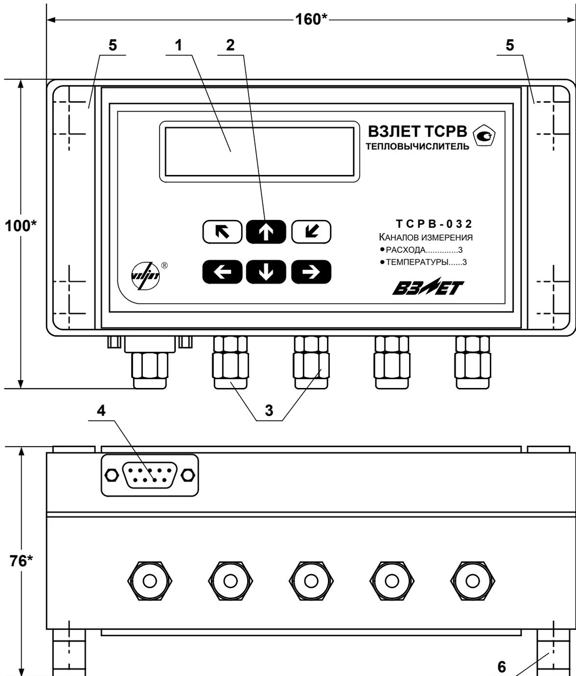
1 – дисплей индикатора; 2 – кнопки управления; 3 – гермоводы кабелей связи с ПР и ПТ; 4 – разъем RS-232; 5 – декоративная планка; 6 – кронштейн для крепления на DIN-рейку.
