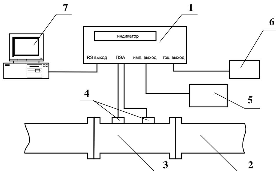
1 – вторичный преобразователь поверяемого расходомера; 2 – трубопровод поверочной установки; 3 – измерительный участок; 4 – преобразователи электроакустические; 5 – частотомер; 6 – миллиамперметр; 7 – персональный компьютер.
