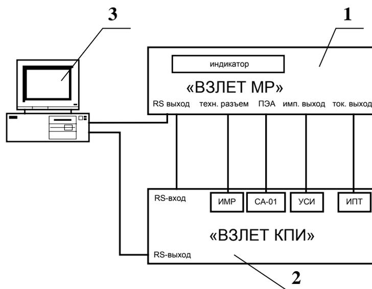
1 – вторичный преобразователь поверяемого расходомера; 2 – комплекс поверочный «ВЗЛЕТ КПИ»; 3 – персональный компьютер.
