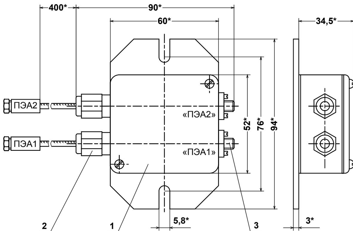
1 – корпус устройства; 2 – кабели для стыковки с ПЭА; 3 – разъемы для подключения кабелей связи с ВП.
