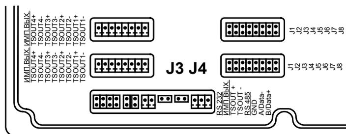
Обозначение коммутационных элементов комбинированного модуля «RS-232 / RS-485 / универсальный выход 0» в окне Г
