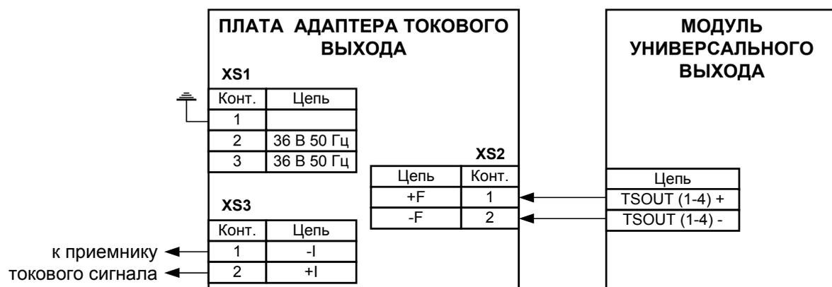
Рис. В.2. Схема подключения платы адаптера.
