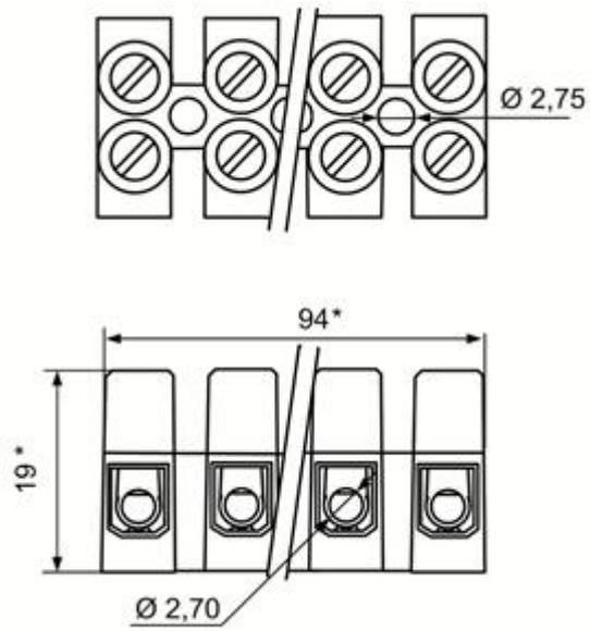
Рис.А.10. Клеммная колодка.
