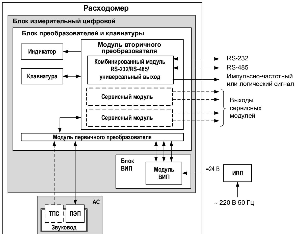
AC – акустическая система; ВИП – встроенный источник питания; ИВП – источник вторичного питания; ПЭП – пьезоэлектрический преобразователь; ТПС – термопреобразователь сопротивления.
