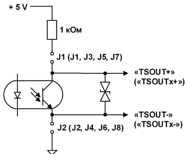
Рис.Б.1. Схема оконечного каскада универсальных выходов.
