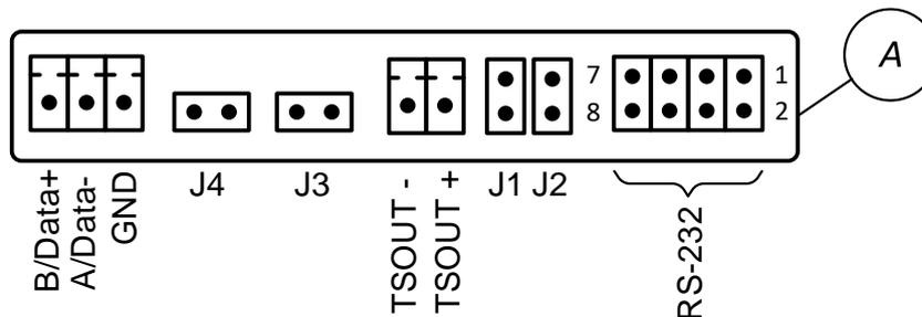
Рис.В.2. Коммутационные элементы комбинированного модуля.
