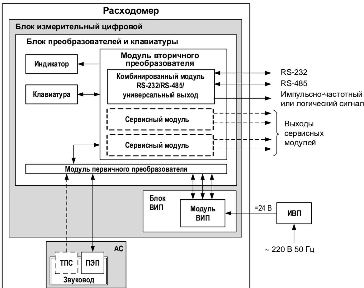
*АС – акустическая система; ВИП – встроенный источник питания; ИВП – источник вторичного питания; ПЭП – пьезоэлектрический преобразователь; ТПС – термопреобразователь сопротивления.*
