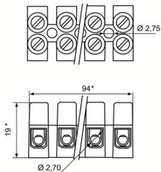
**Рис.А.10. Клеммная колодка.**
