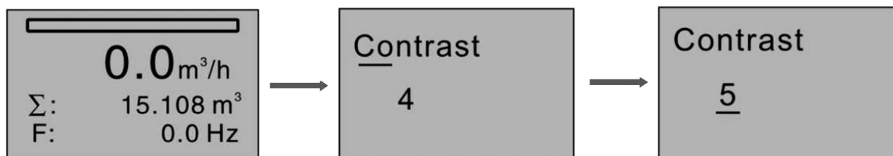
Рис.7. Настройка контрастности дисплея
