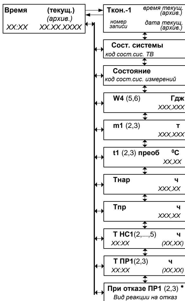
Рис. 3. Структура окон индикации буферного накопителя (архивной записи).
