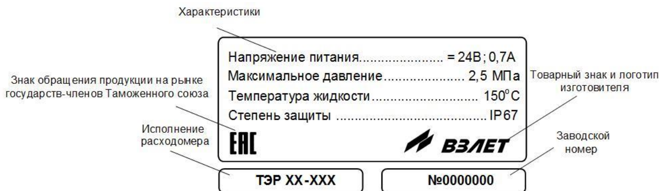
Рис.1. Шильд на блоке электроники расходомера.
