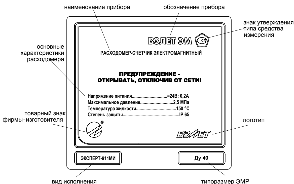
Рис.3. Вид маркировки блока измерения расходомера.
