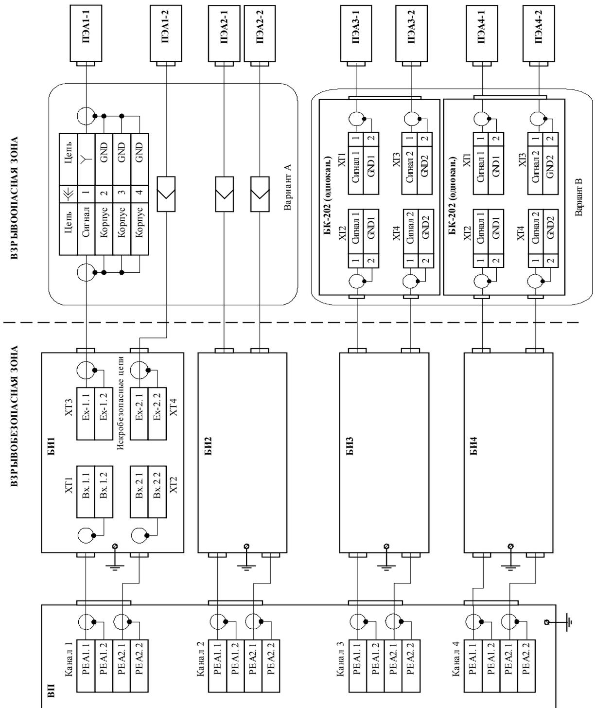
**Рис.Г.2. Варианты подключения с использованием одноканальных блоков коммутации.**
