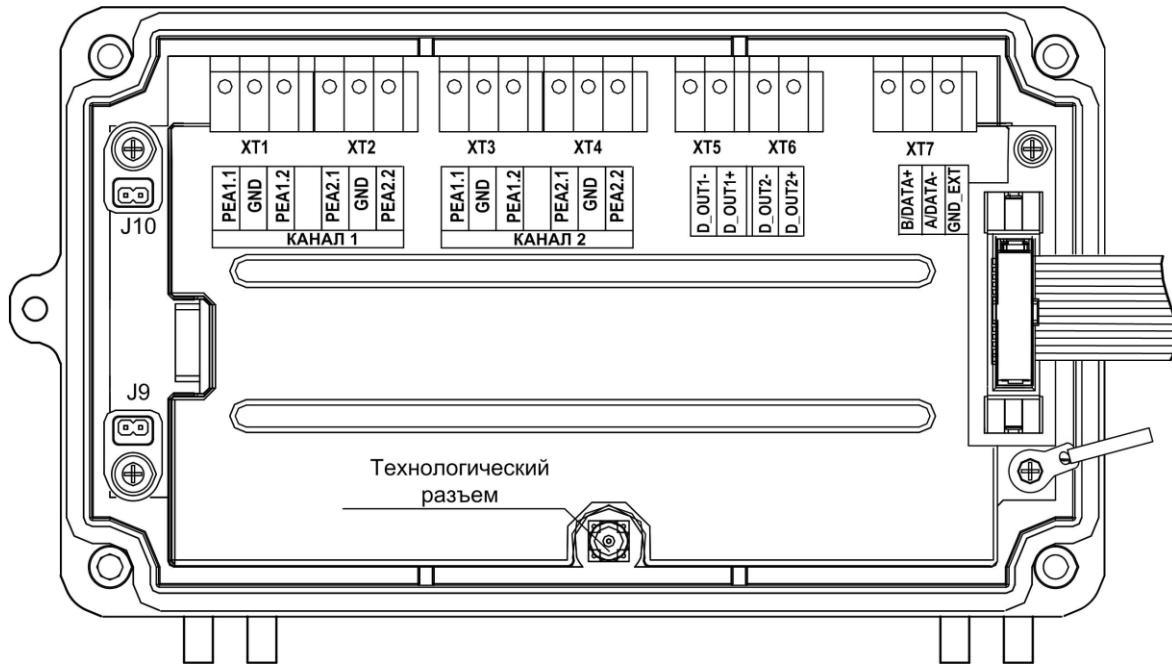
XT1...XT4 – клеммные колодки подключения кабелей связи с ПЭА;
