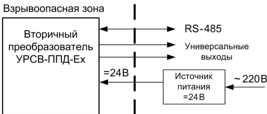
Рис.4 - Структурная схема вывода информации одиночного расходомера
