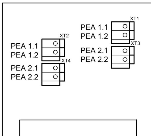
Рис.А.5 - Плата устройства коммутационного первичного преобразователя
