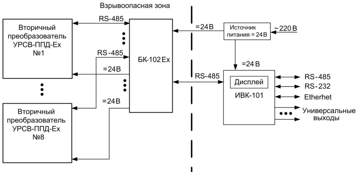
Рис.6 - Структурная схема сбора данных и выносной индикации для нескольких расходомеров.
