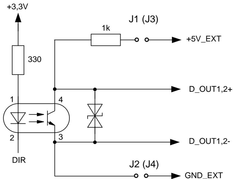
Рис.В.4 - Схема оконечного каскада универсальных выходов
