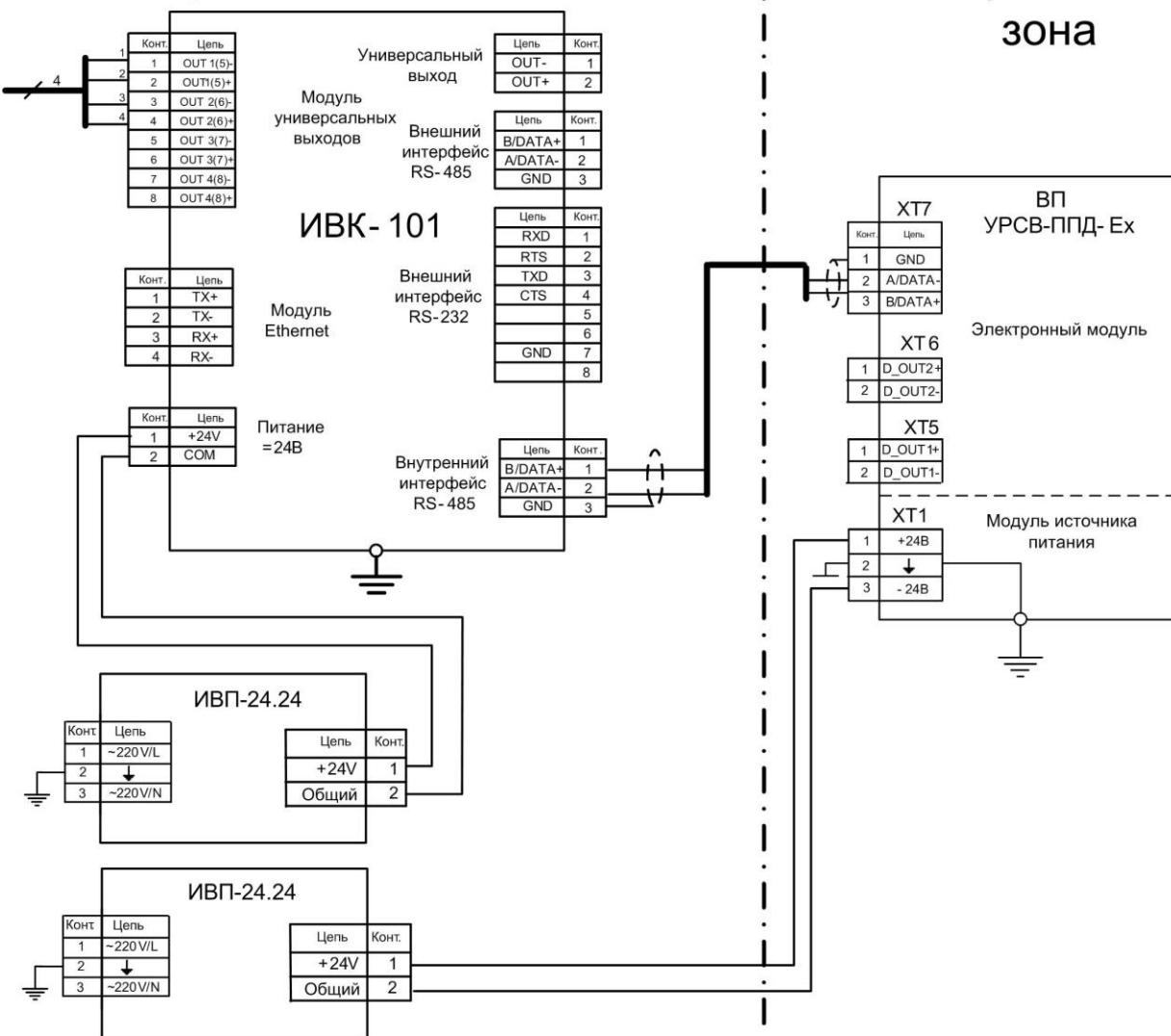
Рис.В.2 - Схема подключения одного расходомера УРСВ-ППД-Ех к блоку ИВК-101
