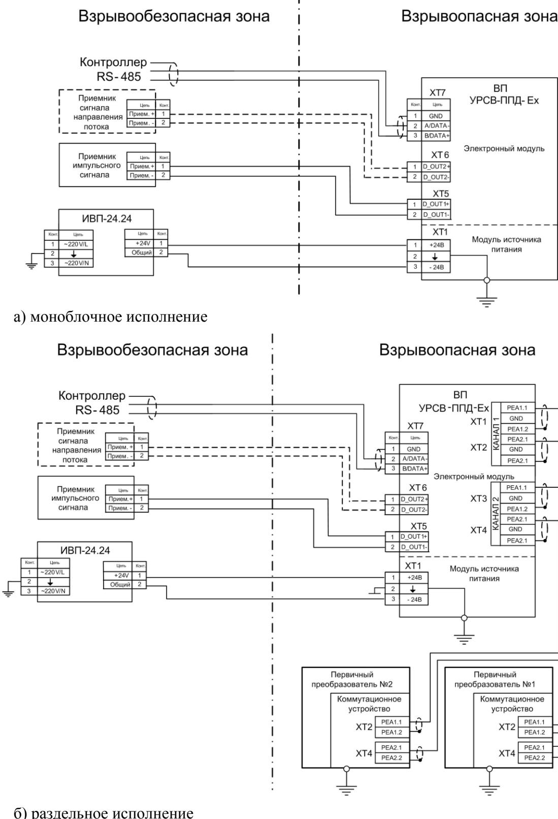
Рис.В.1 - Схема соединений расходомера УРСВ-ППД-Ex
