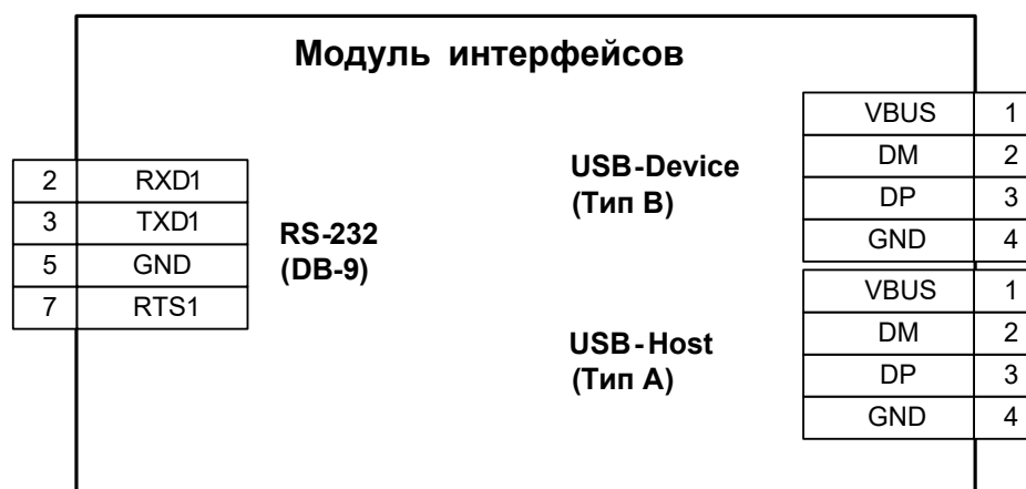
Рис.Б.3. Схема подключений модуля интерфейсов.
