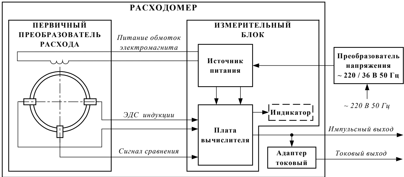
Рис. 1. Структурная схема расходомера.
