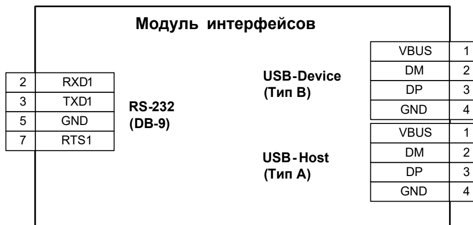
Рис.Б.3. Схема подключений модуля интерфейсов.
