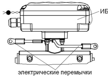
**Рис.10. Электрические перемычки на ИБ расходомера.**
