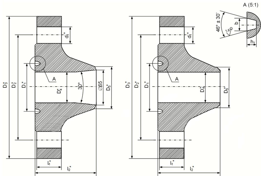
а) DN/D<sub>тр</sub> 32/50 с переходом на DN80      б) остальные типоразмеры
