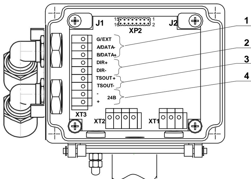
*XT1, XT2 – технологические контактные колодки; XT3 – контактная колодка внешних связей и питания; XP2 – контактная колодка подключения модуля индикации, модуля токового выхода или модуля активного режима универсальных выходов; J1 – контактная пара разрешения модификации калибровочных параметров; J2 – контактная пара разрешения модификации сервисных параметров.*
