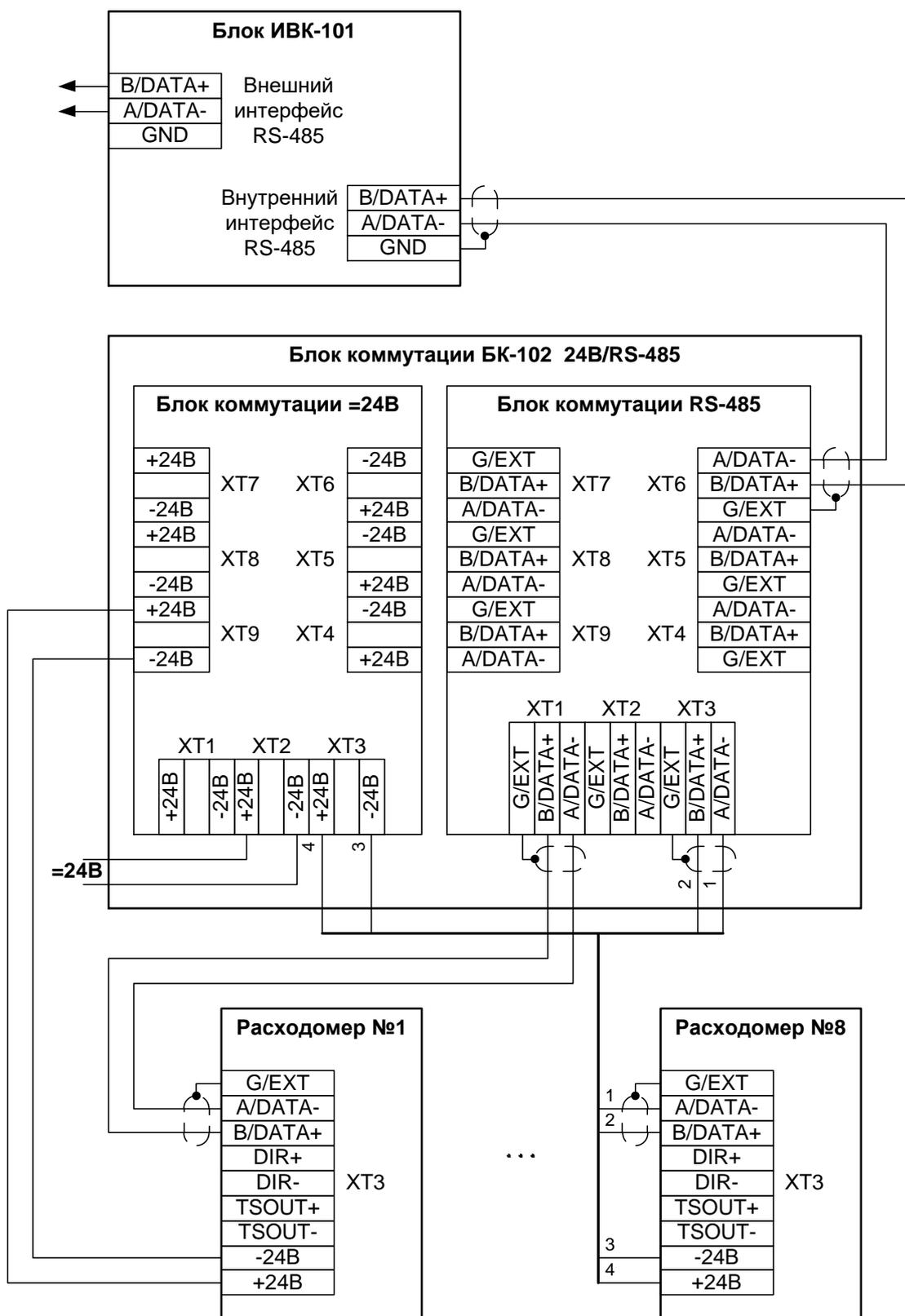
Рис.Г.2. Схема подключения от 2 до 8 расходомеров по интерфейсу RS-485 к блоку ИВК-101, а также подключение расходомеров по цепи =24 В с использованием БК-102 24В/RS-485.
