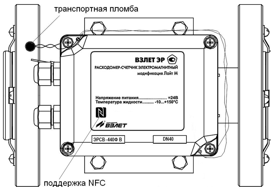
а) корпус измерительного блока выполнен из полимера
