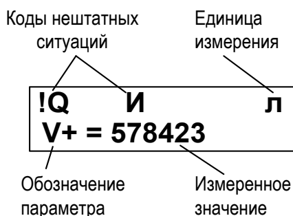
Рис.4. Размещение информации на индикаторе расходомера.
