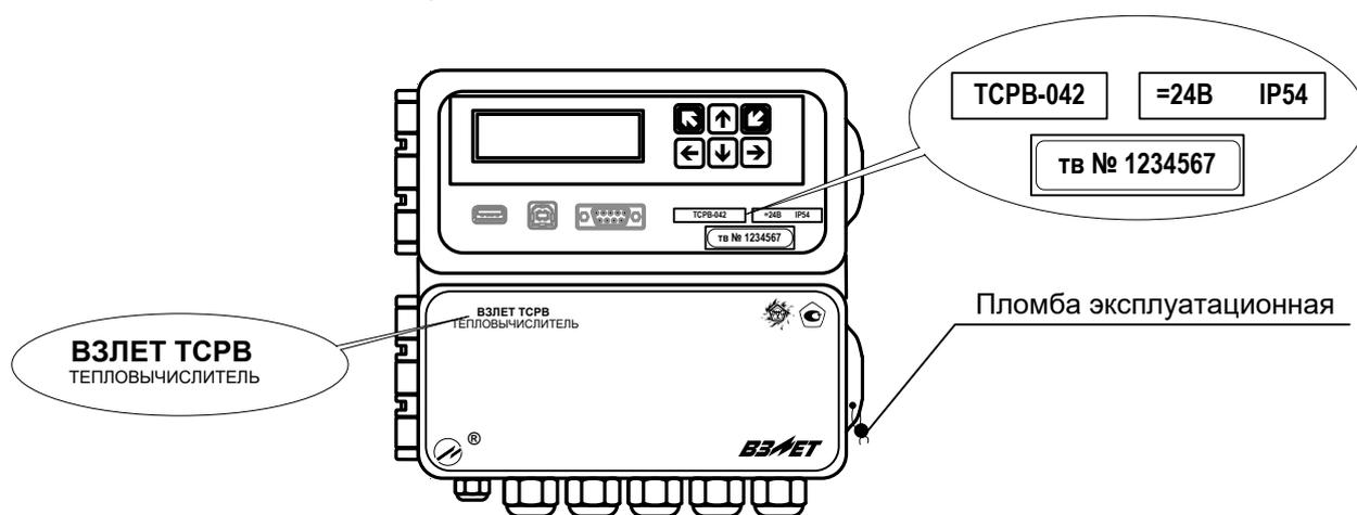
**Рис.2. Вид и размещение маркировки и возможных мест пломбирования корпуса ТВ.**
