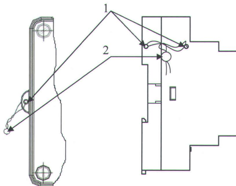
Рисунок 2 - Схема пломбировки преобразователей измерительных «ВЗЛЕТ АС»
