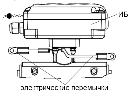
Рис.9. Электрические перемычки на ИБ расходомера.
