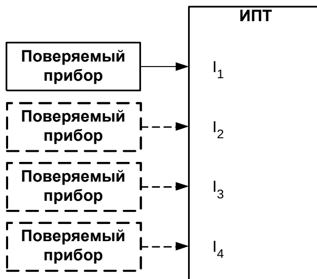
Рис.13. Схема сопряжения поверяемых приборов с ИПТ.
