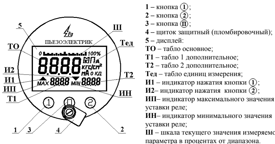
Рисунок 10 – Лицевая панель блока индикации и управления датчиков моделей 5XXX.
