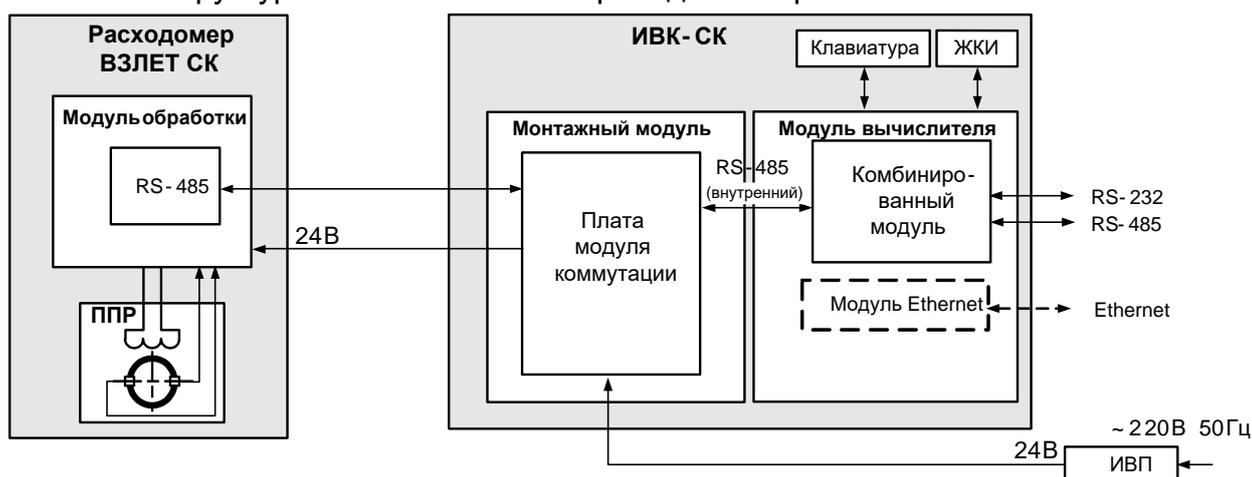
ППР – первичный преобразователь расхода; ЖКИ – жидкокристаллический индикатор; ИВП – источник вторичного питания
