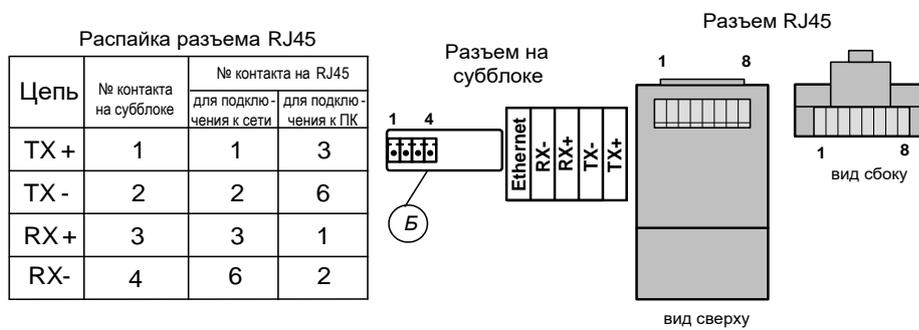
**Рис.А.4. Обозначения коммутационных элементов на субблоке вычислителя адаптера ИВК-СК.**
