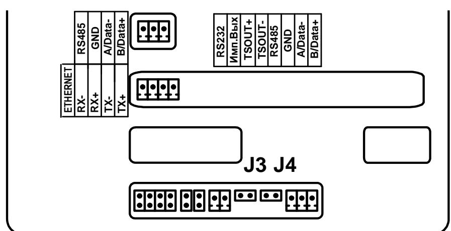
Подключение к сети Ethernet при установленном разъеме в окне Б.
