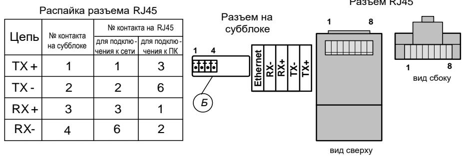
**Рис.А.4. Обозначения коммутационных элементов на субблоке вычислителя адаптера ИВК-СК.**
