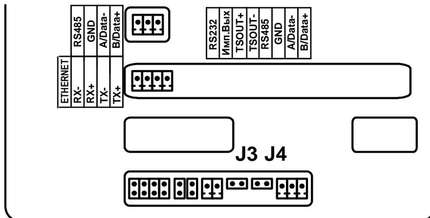
Подключение к сети Ethernet при установленном разъеме в окне Б.
