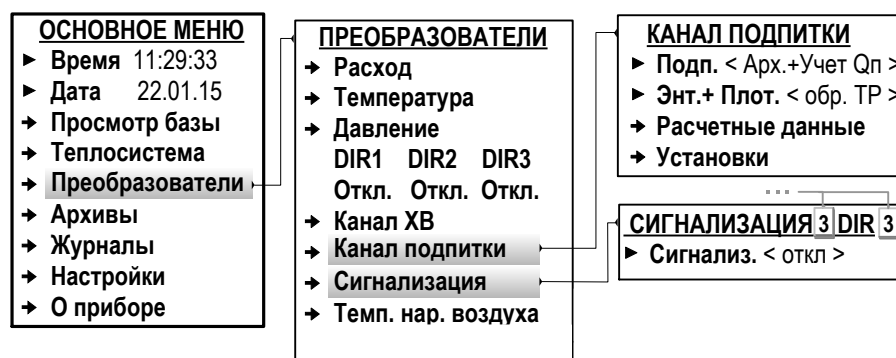
Рис.34. Вид меню «Канал подпитки» (режим СЕРВИС).
