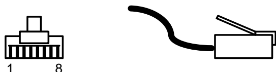
а) вид и нумерация контактов разъема RJ45
